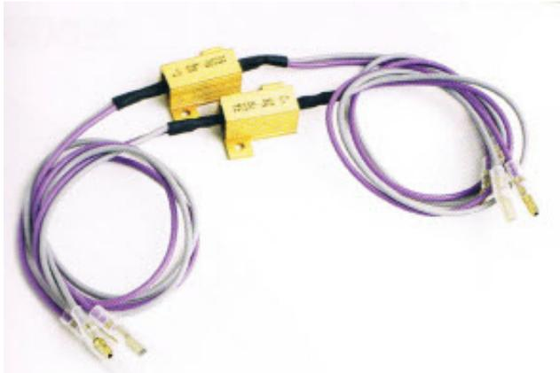
El empleo de las resistencias PUIG en paralelo equilibra la frecuencia de parpadeo de los intermitentes de leds,compensando la perdida de potencia que supone pasar de bombillas a leds.
